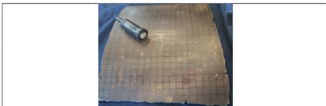
Figura 6 – Marcação da região a inspecionar para varredura através de “malha”
